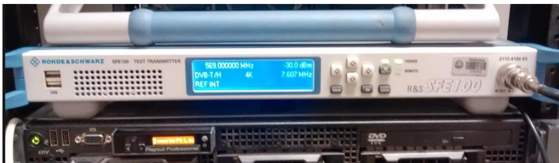
Figura 31 - Transmissor de Teste Utilizado Como Gerador de Ruído nos Experimentos
